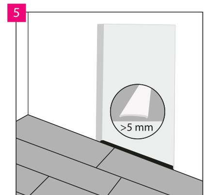
Рекомендуется применять 5 мм компенсационный зазор в дверном проеме между комнатами, который позволит избежать напряжений в случаях: неправильной формы поверхности пола в соседних комнатах, размещения тяжелой мебели в одной из комнат или использования пола с подогревом только в одной из смежных комнат и/или контроллеров температуры в отдельном помещении. В случае, если площадь пола больше 200 м<sup>2</sup> или длиннее 20 м, компенсационные зазоры необходимо увеличить до 10 мм.
