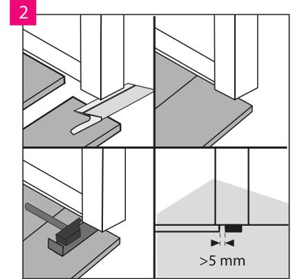
У дверей рекомендуется подрезать профили дверных коробок и оставить свободное пространство над установленной панелью, чтобы не ограничивать ее возможное перемещение.
