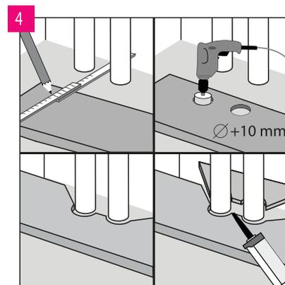
Действуйте аналогично в случае большего количества труб системы отопления. Вырезанные элементы панели следует соединять с помощью монтажного клея для пластиковых элементов.
