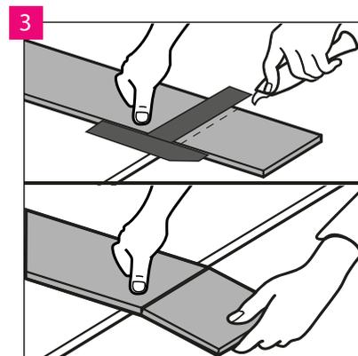
Для дополнительной обрезки панелей используйте острый нож, надрежьте верхний слой, а затем динамично отломайте панель, наклонив ее по краю. Панели для пола также можно легко разрезать с помощью электрической пилы.
