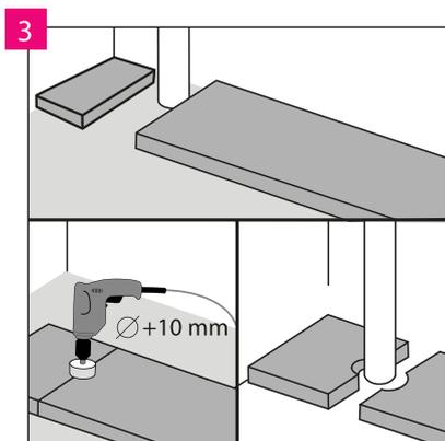
В случае вертикальных труб, встроенных в основание, оставьте свободное пространство вокруг труб. Отверстия для труб следует просверлить сверлом, диаметр которого больше диаметра трубы на 15 мм.
