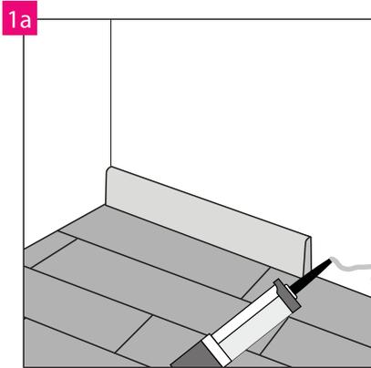
Компенсационные зазоры вдоль стен необходимо закрыть плинтусом, монтируя его с помощью клея или специальных зажимов. Рекомендуется использовать плинтусы Arbiton, предназначенные для данной панели, что гарантирует превосходное соответствие цвета и устойчивость покрытия к царапинам.
