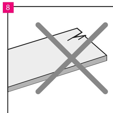
До и во время установки контролируйте панели в условиях оптимального освещения. Не используйте дефектные панели.
