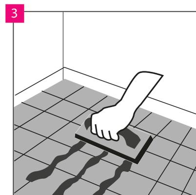
В случае установки на основание, покрытое керамической плиткой, заполните стыки плитки с зазором шире 4 мм и глубже 1 мм прочным составом для заделки швов, например, эпоксидной смолой. Укладка допускается на плитку со швами не шире 5 мм и глубиной 1 мм без использования выравнивающего состава, при условии использования подложки марки Arbiton или Ewifoam, которая предназначена для монтажа жестких и LVT полов.
