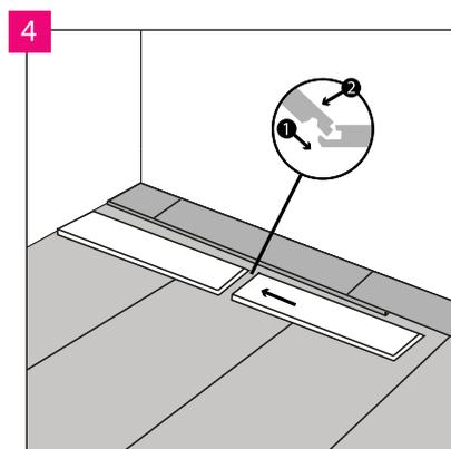
Панели снабжены замковыми соединениями на короткой и длинной стороне. Сначала соедините короткие стороны соседних панелей.
